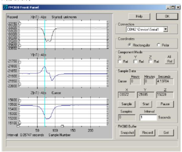
ハンドルは、ストリップチャートバッファーのサンプル点の数が525以下のときはいつでも水平軸の最も遠い端にあります。サンプル点が525を越えて増加すると、左ハンドルは右ハンドルの方へ進みます。ハンドル間の間隔は、バッファーの測定点数を示し、間隔が狭いほど、測定点数は多いです。
