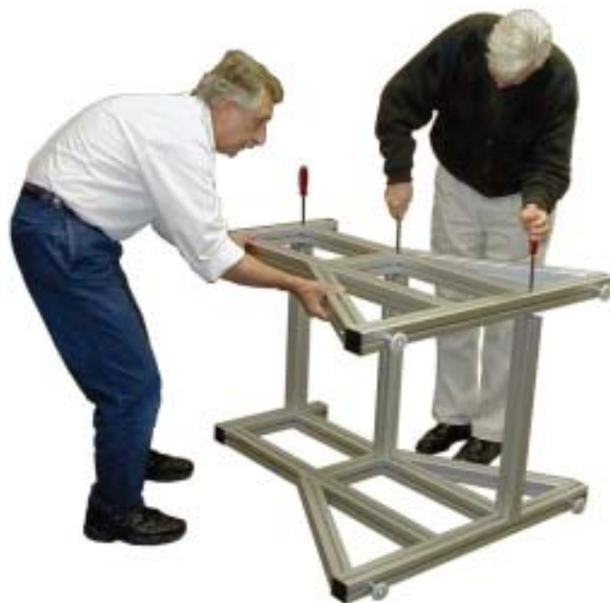
図 12 右フレームの取り付け
